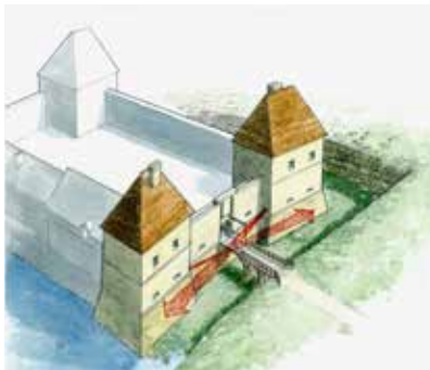
Fig. 2 : Les angles de tir du front bastionné protègent le pont-levis. L. Duigou del. Le fauconneau au début du XVI e siècle. L. Duigou del.
